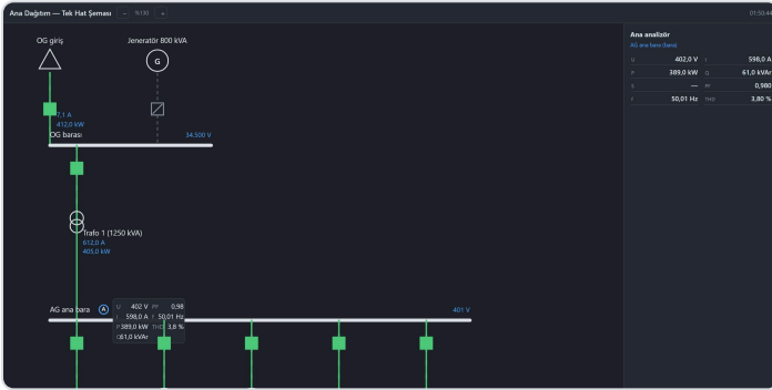
Elektrik tek hat – yapıdan otomatik çizilen şema, analizör değerleri
